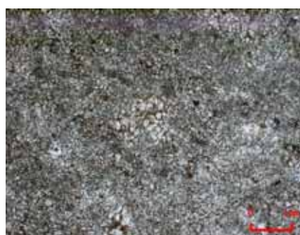
2.含生物碎屑亮晶砂屑灰岩 正交偏光, 40×
