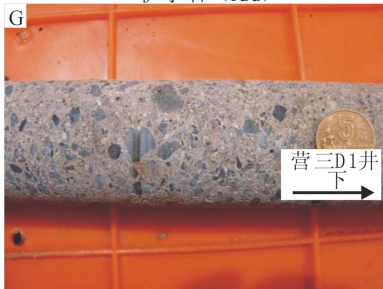
流纹质沉火山角砾岩 (Y3D1-242.2m) 角砾见流纹岩、砂岩、变质岩、珍珠岩 含大量炭屑; 晶屑主要为石英、长石
