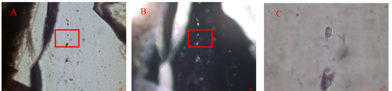
图2 徐深1井(3444.62 m)穿石英颗粒裂纹中捕获的发浅蓝色荧光的气液两相含烃盐水包裹体
